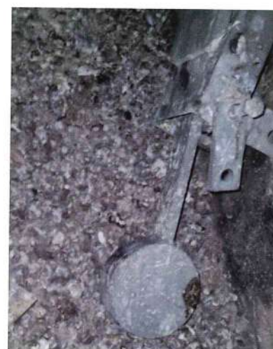
Le marteau hors service, n'est plus dans son axe d'origine
